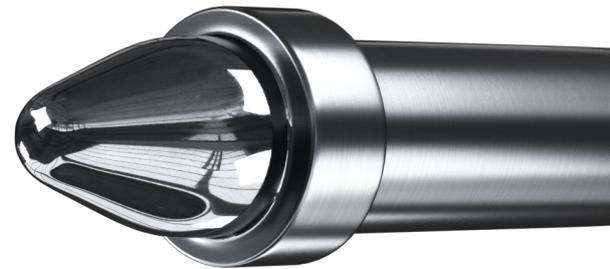
„Die DLC-basierte CARBON-X®-AL-Beschichtung vereint die hohe Härte von Diamanten mit der Schmierfähigkeit von Graphit, was ihren Einsatz unter Mangelschmierungsbedingungen ermöglicht. Die Kombination dieser Eigenschaften, zusammen mit der hohen abrasiven Verschleißfestigkeit, macht CARBON-X®-AL zu einer hervorragenden Schutzschicht für Werkzeuge in der Aluminium-Kaltumformung.“
