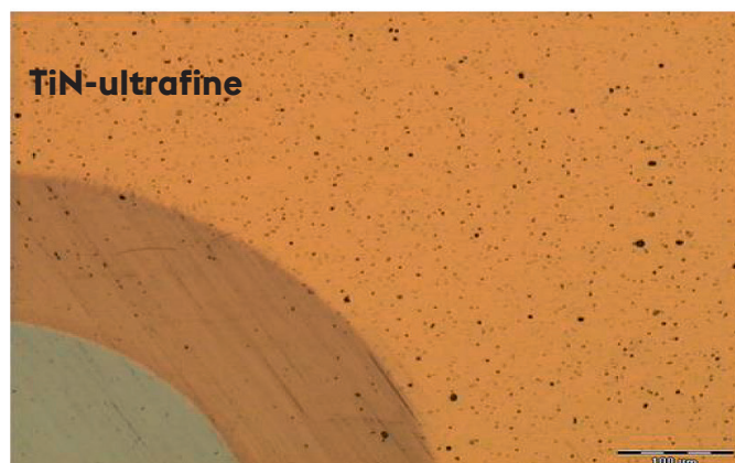
Abb. 1: Oberfläche mit Kalottenschliff einer Standard TiN (oben) und einer TiN-ultrafine (unten)
